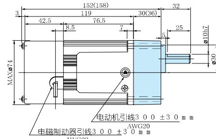
※( )内尺寸表示的是M X 7 G □B (M ) (减速比1 / 30以上)的尺寸。
