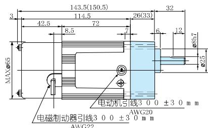
※( )内尺寸表示的是M X 6 G □B (M ) (减速比1 / 30以上)的尺寸。
