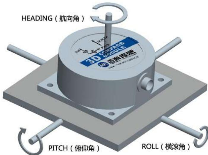
尽管 HCM385 能够补偿磁干扰，但是用户应该选择一个磁干扰最小的环境来安装和使用。尽可能的选择远离铁、镍、磁铁、发动机和其他磁性物质放置 HCM385。如果周围有这些磁介质，请至少需要维持 0.5m 远的距离。为保证产品达到最佳测量效果，安装时须采用非磁性螺丝刀和非铁质螺丝。**务必严格避免磁铁、电动机等强磁物质靠近罗盘 10cm 之内，这可能会造成罗盘的测量精度不可逆下降。**
