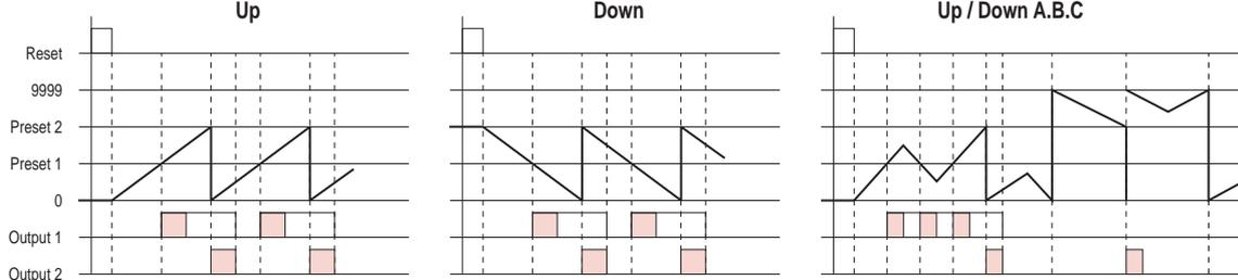
**R** 输出模式: 显示值在单击输出时间后回到Reset起始状态。输出动作为重复单击输出。Output1自保持输出, 在Output2单击输出时间后停止。Output1之单击输出时间与Output2是各自独立的。
