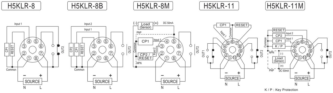
注:图中的Common在NPN型时 = 0V, 在PNP型时 = +V (NPN型与PNP型的选择可由参数设定中选择)
