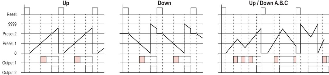
**C** 输出模式: 显示值和计数向上同时回到Reset起始状态。不显示计数向上之值。输出动作为重复单击输出。Output1自保持输出, 在Output2单击输出时间后停止。Output1之单击输出时间与Output2是各自独立的。
