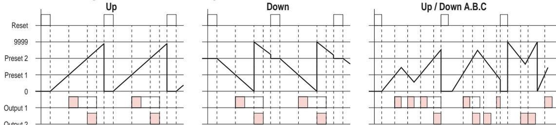
**P** 输出模式: 显示值在单击输出时间内不会改变, 但计数完成同时回到Reset起始状态。输出动作为重复单击输出。Output1自保持输出, 在Output2单击输出时间后停止。Output1之单击输出时间与Output2是各自独立的。
