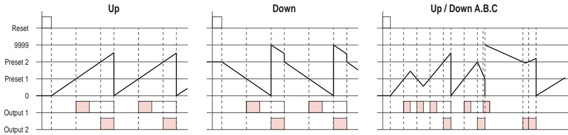
**A 输出模式：**显示值与Output1自保持输出一直保持到Reset输入。Output1与Output2是各自独立的。
