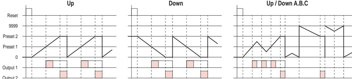
**K** 输出模式: 显示值持续计数。Output1自保持输出, 在Output2单击输出时间后停止。Output1之单击输出时间与Output2是各自独立的。
