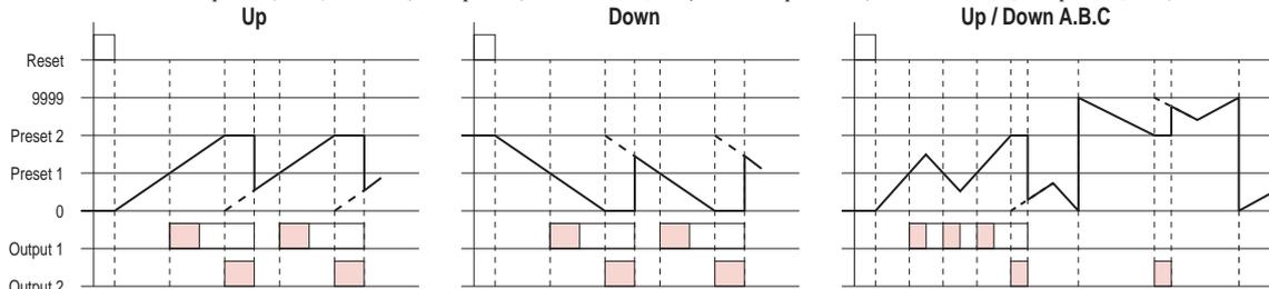
**Q 输出模式：**显示值会持续计数，而单击输出时间后回到Reset起始状态。输出动作为重复单击输出。
