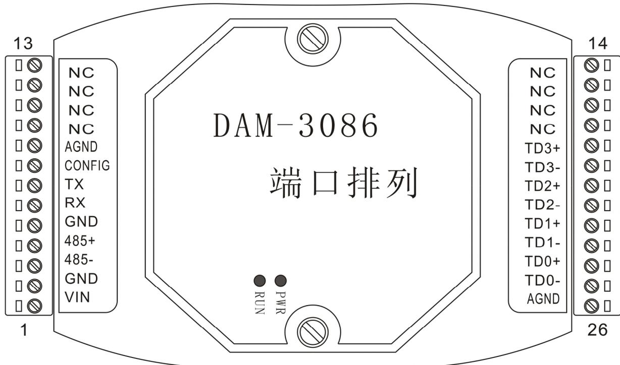
图 4-1 DAM-3086 模块端口位置示意图
