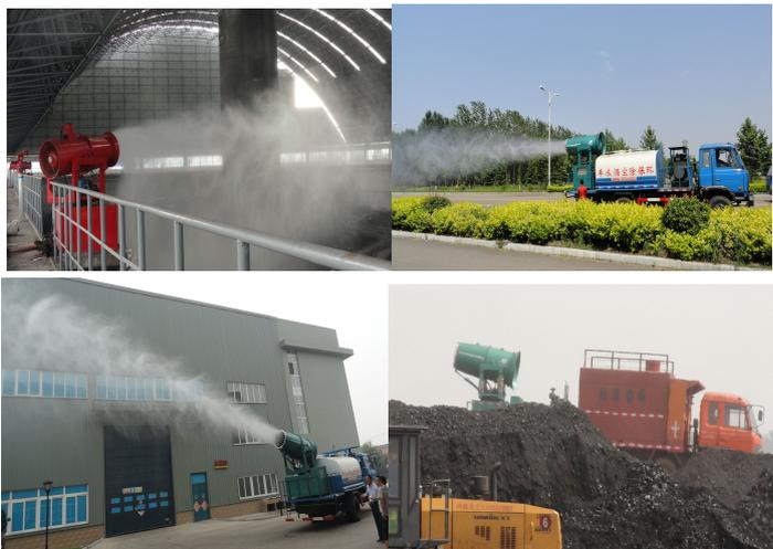
图 1 远射程喷雾风机应用
