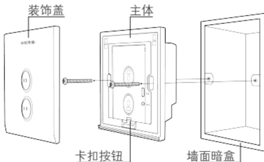
3、卡上装饰盖，安装完成（卡上装饰盖前，请先进行联网设置）。
