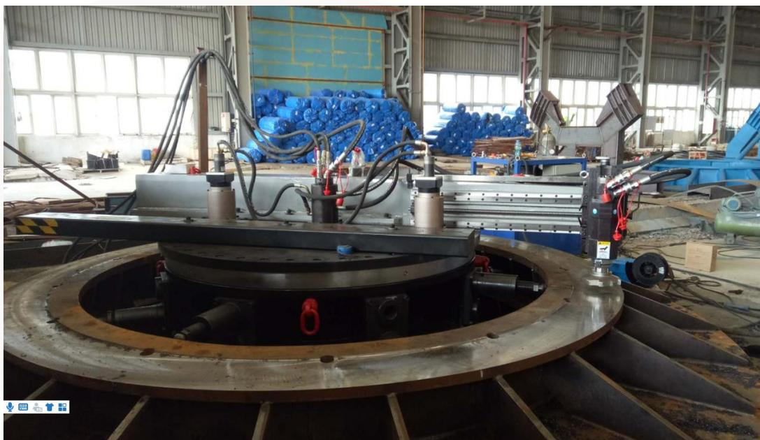
FDG4500 便携式法兰端面加工机产品主要用于核电、造船、石化、海洋石油、工程机械、冶金等众多领域。我们的目标不仅仅是为各领域的用户提供专业的安装、检修设备，更在于在业界推广这种先进的检修理念，分享丰富的行业应用经验，专业致力于为安装、检修等工艺技术提供创新型解决方案。
