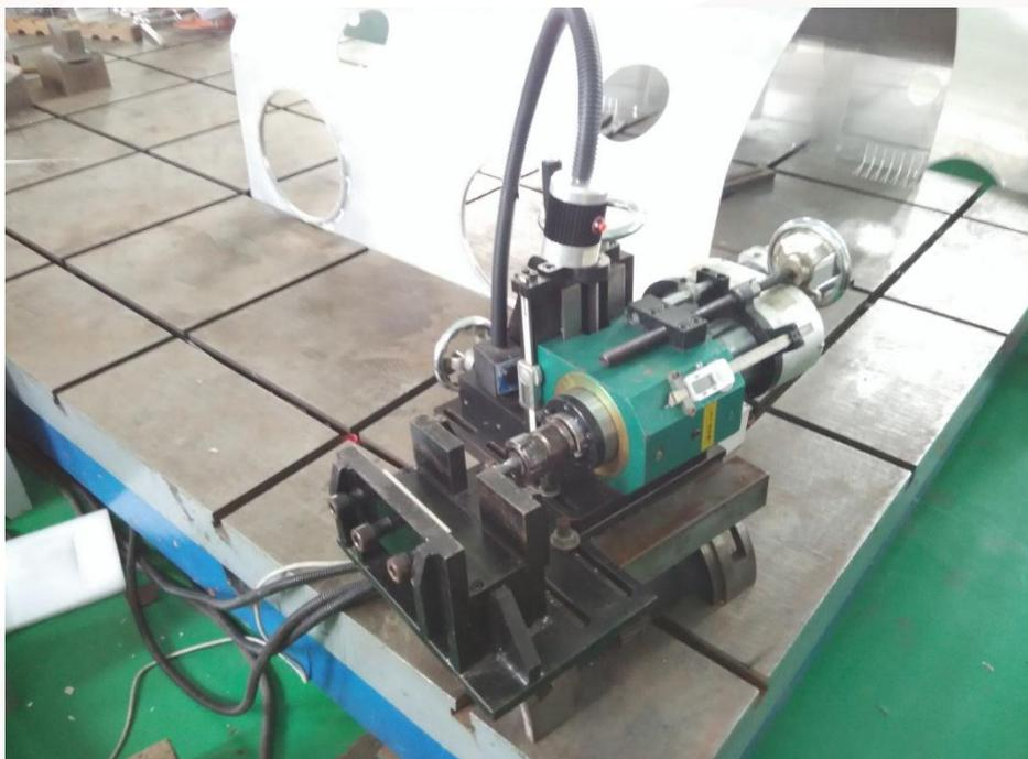
18. 俄罗斯，型号：LMD3000，床身材质：锻件，导轨：直线导轨，动力：液压，
