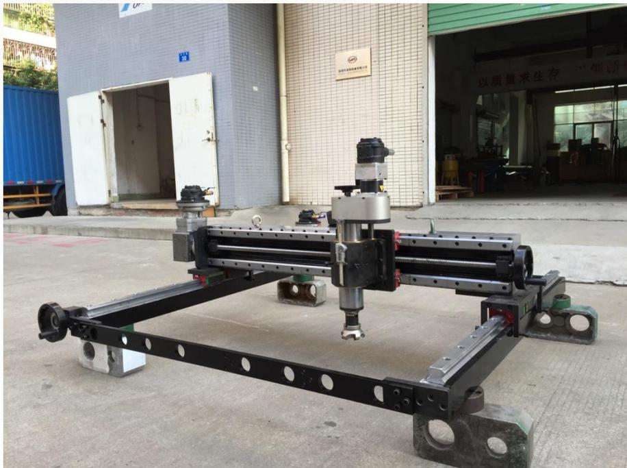
15.客户名称：太原钢厂，型号：XDG1000-B，床身材质：锻件，导轨：直线导轨，动力：1KW 伺服电机。时间：2014年。
