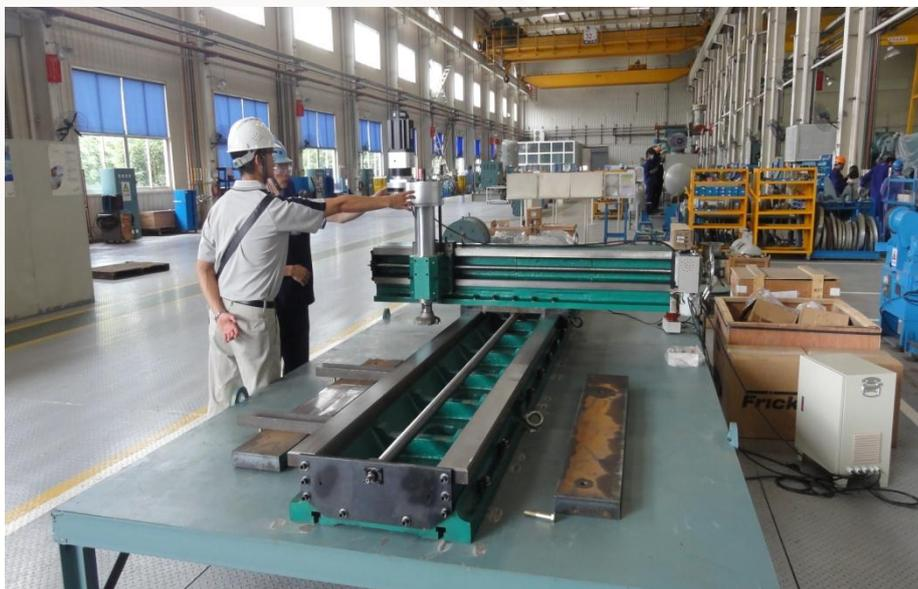
5. 客户名称：天津华油天元石化设备有限公司，型号：XDG1000-C，床身材质：锻件+铝镁合金，铣削动力：液压。时间：2011 年
