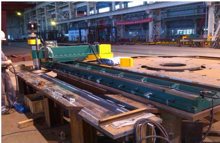
9. 客户名称：蓬莱巨涛海洋工程重工，型号：XDG2000-C,床身材质：锻件+铝镁合金，导轨：燕尾+直线导轨，动力：液压. 时间：2012 年
