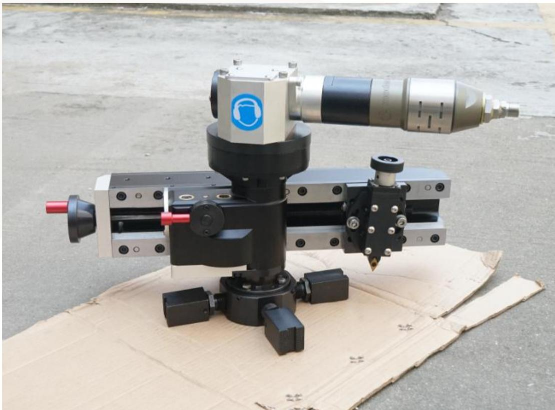
21.客户名称：河北敬业集团，型号：XDG-D3000 便携式龙门铣床，床身材质：锻钢，导轨：直线导轨，动力：液压泵站. 时间：2017 年
