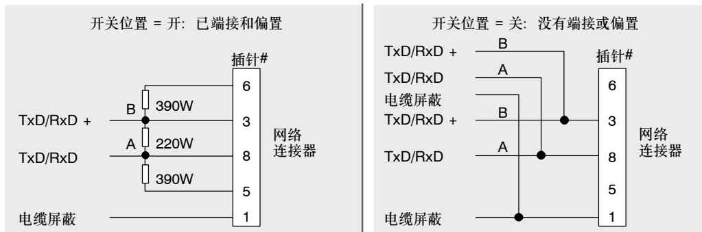
图11-5 网络电缆的偏置和端接
