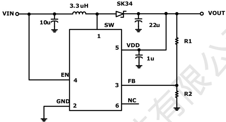
注：芯片 5 脚 VDD 端可以接 VOUT 也可以接 VIN，当 VIN<5V 时，建议接 VOUT 来增强驱动能力。
