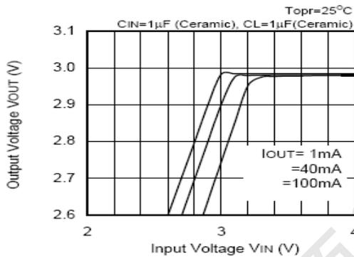
Dropout 电压和输出电流
