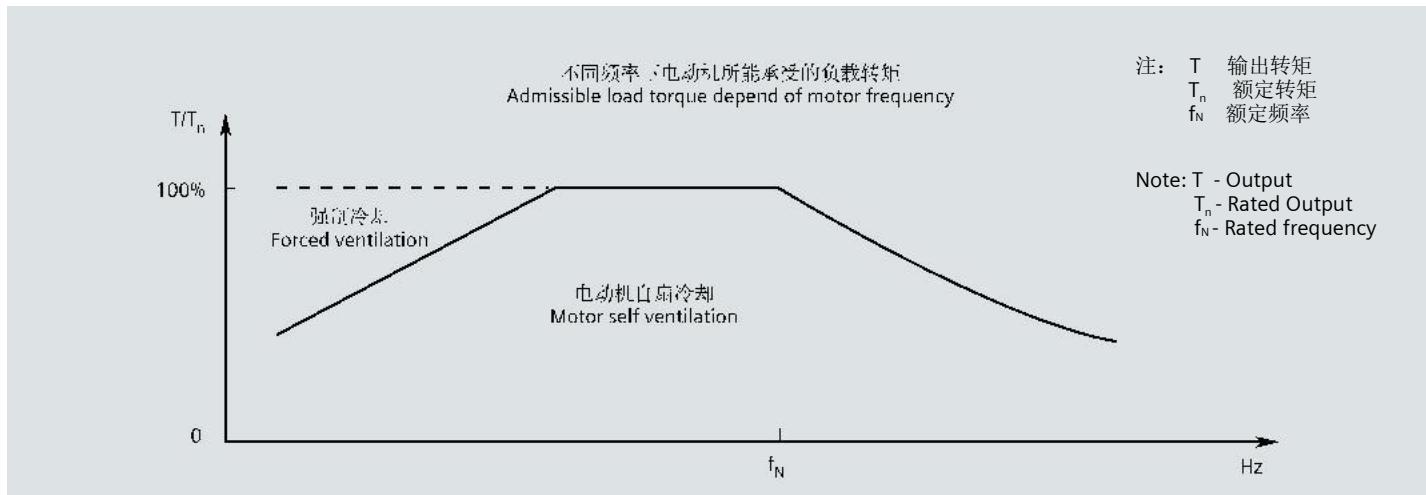
当负载转矩在允许的转矩范围内时，电动机能够自扇冷却；当负载转矩超过所允许的转矩时，电动机需要强迫冷却。
