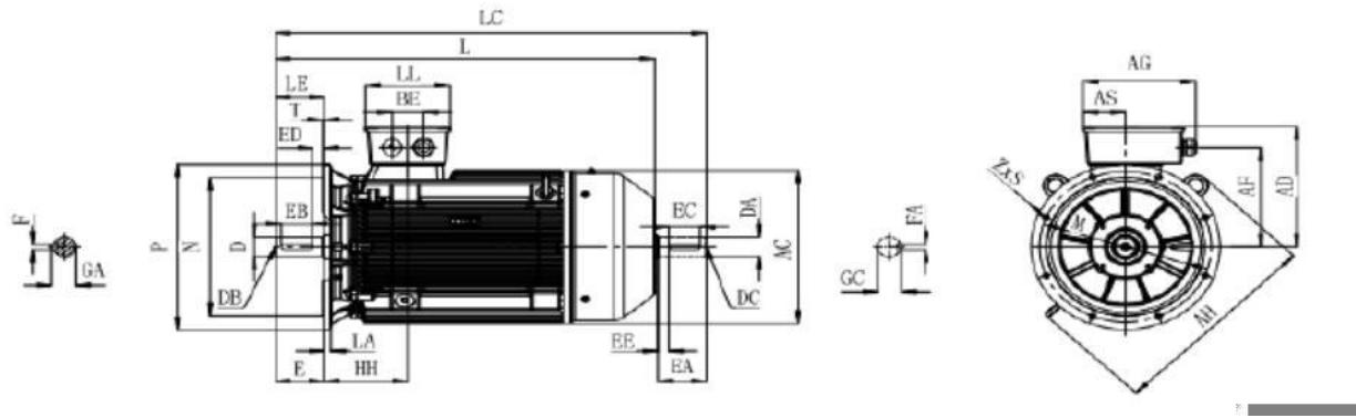
IM B14安装方式 Type of construction IM B14
