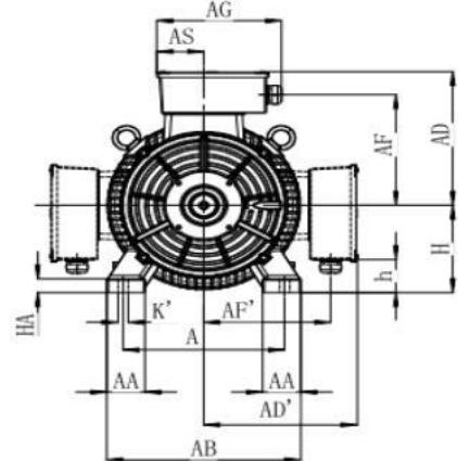
IM B35安装结构方式 Type of construction IM B35
