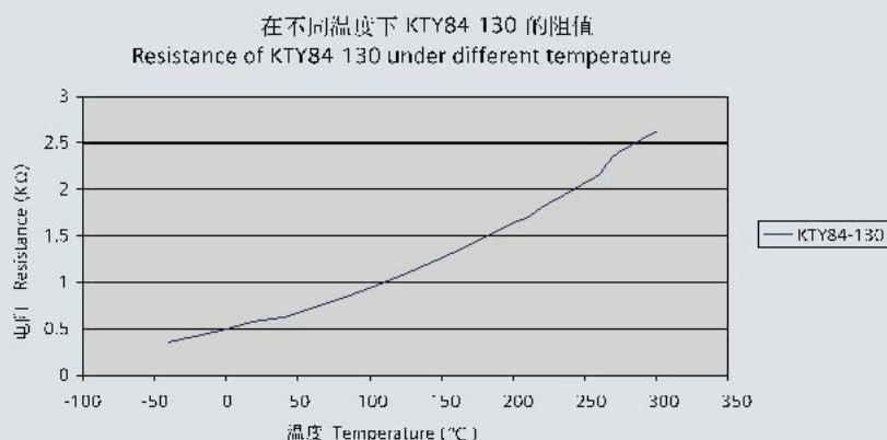
一些西门子变频器可以通过温度传感器的电阻来确定电动机的温度，从而设定电动机报警和跳闸的温度。
