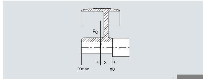
为了计算径向负载的最大悬臂力，据轴肩处的悬臂力  $F_Q$  (N) 必须位于轴伸端以内，(长度为  $x$ )。长度  $x$  [mm] 是距离轴肩的距离。长度最长为  $x_{max}$ ，与轴伸长度相同。总的悬臂力  $F_Q$  使用以下公式计算。
