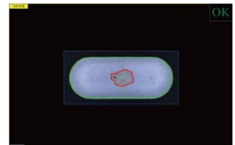
药丸破损检测：检测药丸表面是否有破损，变形，确认外观型号是否正确，有无混入另类品等检测。
