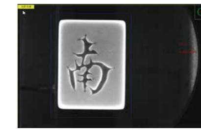
麻将分拣: 识别每一张麻将的类型, 以及识别其所在的位置。通信连接将识别信息发送动作执行机构进行分拣。
