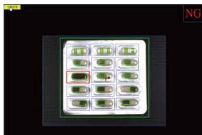
药品胶囊检测: 检测每板胶囊的数量是否正确, 检测每个胶囊槽里的要求颜色是否正确, 有无漏装, 错装。
